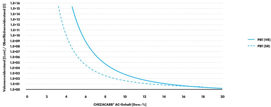
**PBT (MFR = 24 g/10 Min. bei 250 °C/2,16 kg)**
