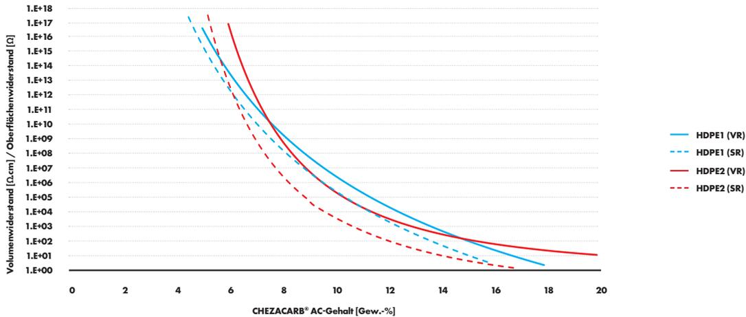
HDPE1 (MFR = 0,15 g/10 min. bei 190 °C/2,16 kg), HDPE2 (MFR = 23 g/10 min. bei 190 °C/2,16 kg)
